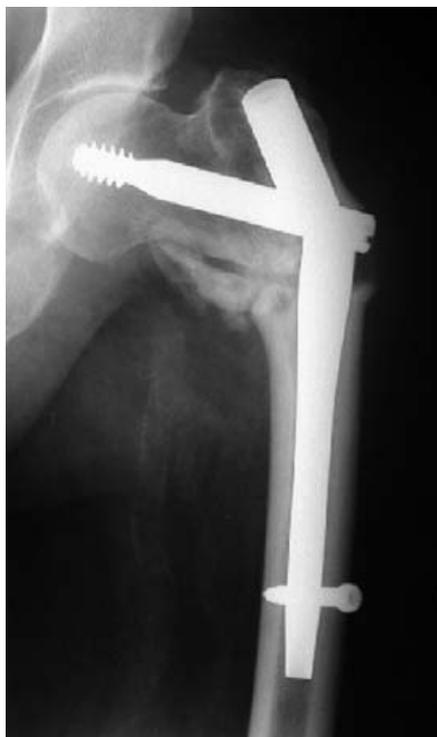
Abb. 2 Ermüdungsbruch des trochanteric Gamma-Nagels.
